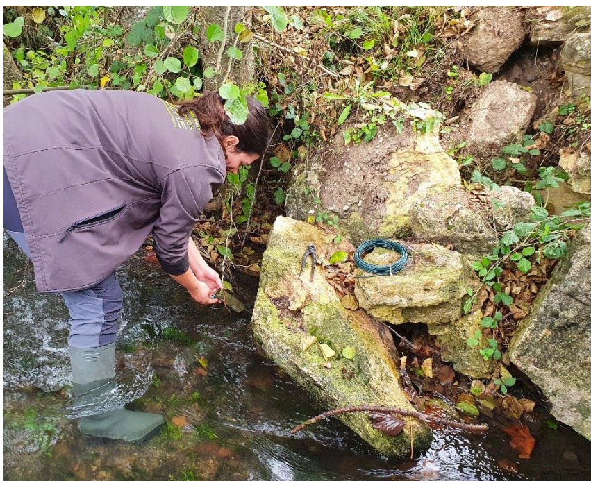
Figure 6 : Installation de la sonde thermique sur le Lunain en octobre 2022
